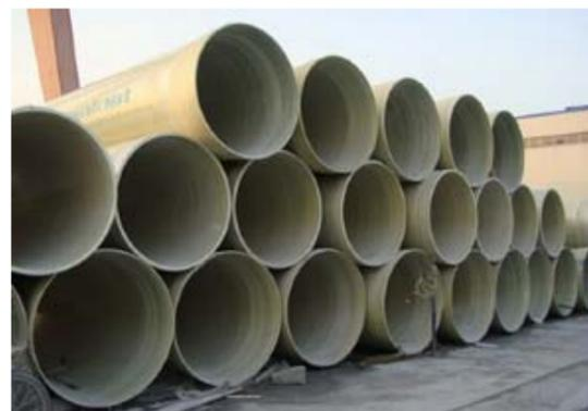
图 9-6 玻璃钢夹砂管（PRM）
